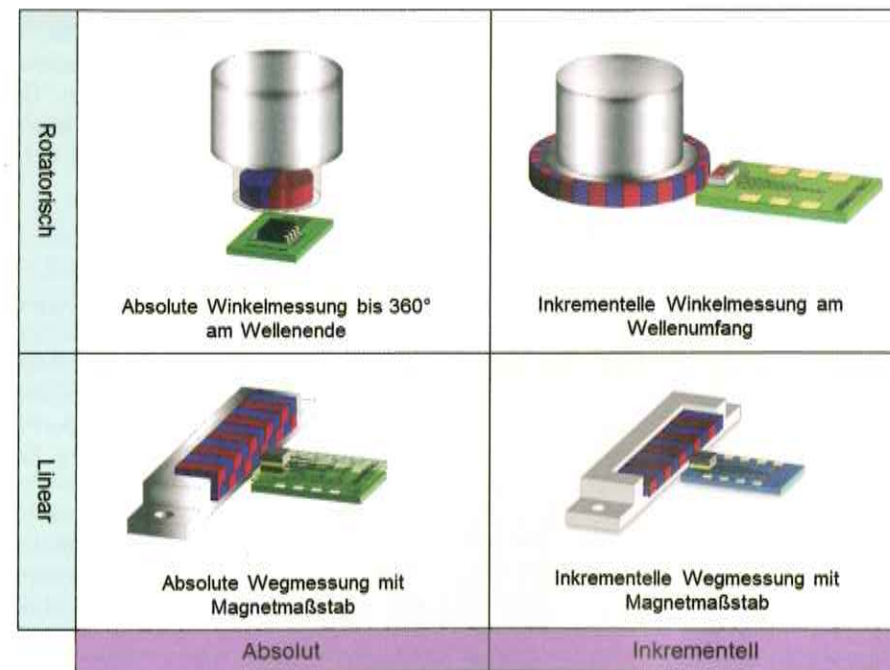
Bild 1 Mögliche Messanordnungen. (Bild © Sensitec GmbH)
