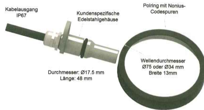
Bild 3 Kompakter TMR-Winkel- und Drehzahlsensor für radiale Abtastung. (Bild © NTN-SNR Bearings)
