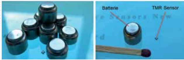
Bild 3: Vergleich des Energieverbrauchs in einer beispielhaften Anwendung der Sensorik (TMR-Sensor rechts im Vergleich zum AMR-Sensor links).
