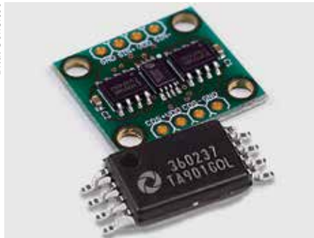
Bild 4: Beispiel eines TMR-Winkelsensors (TA901) für inkrementale und absolute Winkelgeber mit schneller Winkelgeschwindigkeitsmessung (Winkelgeschwindigkeit des Magnetfeldes bis 1 MHz).
