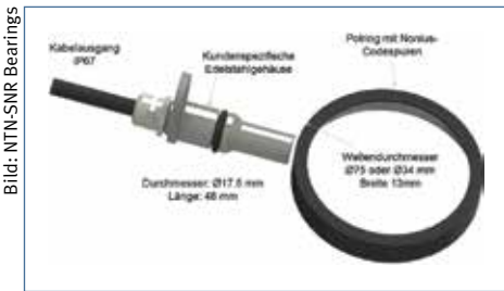
Bild 6: Ein TMR-Winkel- und -Drehzahlsensor für die radiale Abtastung.
