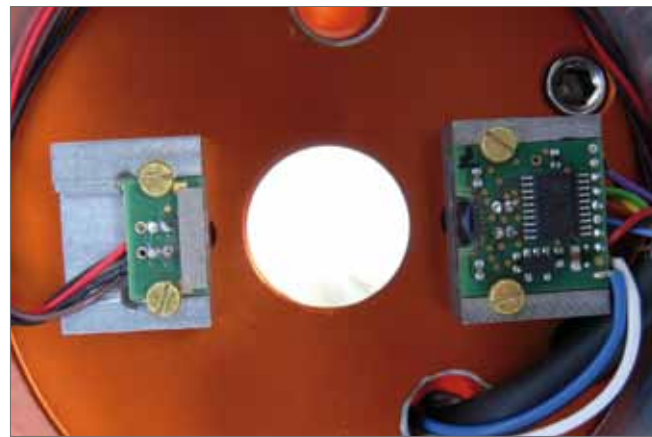
Bild 3: Integration der GLM-Sensormodule (Quelle: Levicron GmbH)
