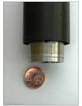
Bild 4: Spindelwelle als Maßverkörperung (Quelle: Levicron GmbH)
