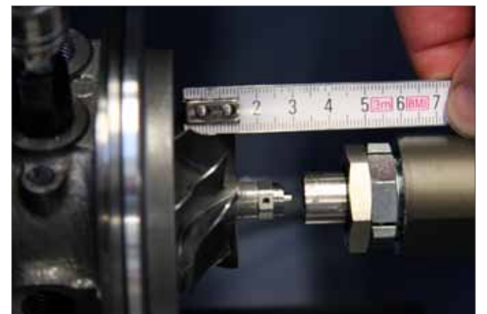
Bild 4: Turbolader und Sensorkopf (Quelle: SchenckRoTec GmbH)
