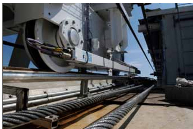
Bild 1 (links) zeigt den berührungslosen Linear-Encoder POMUX KH53 von Sick Stegmann. In den Bildern 2 und 3 wird der Linear-Encoder beim Einsatz für die Positionierung einer beweglichen Dachkonstruktion in der Tele2 Arena in Stockholm dargestellt. Das Fußballstadion verfügt über ein schließbares Dach (Quellen: SICK Stegmann).
