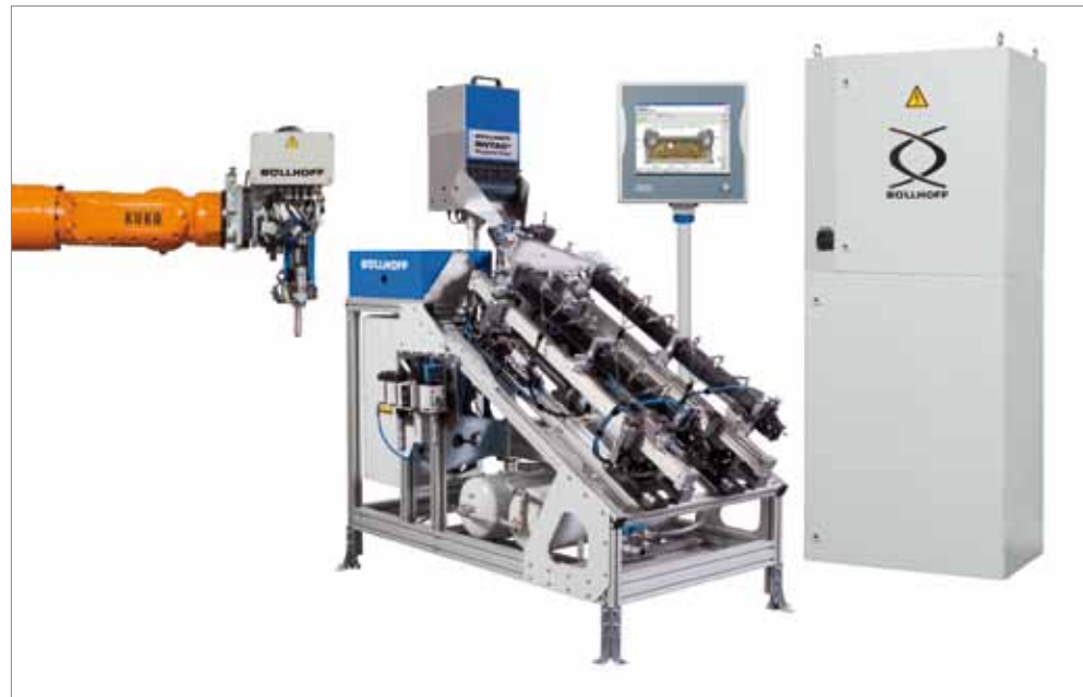
Bild 2: RIVTAC Automation – das System arbeitet vollautomatisch mit Prozessüberwachung (Quelle: Böllhoff Verbindungstechnik GmbH).
