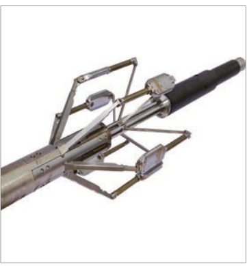
Bild 3: Der Resistivity Imager besitzt sechs Pads, die den spezifischen Widerstand der Formation messen können. Die Öffnungs- und Bewegungen der Arme werden mit MR-Sensoren von Sensitec überwacht. Bildquelle: Antares Datensysteme GmbH, Stuhr
