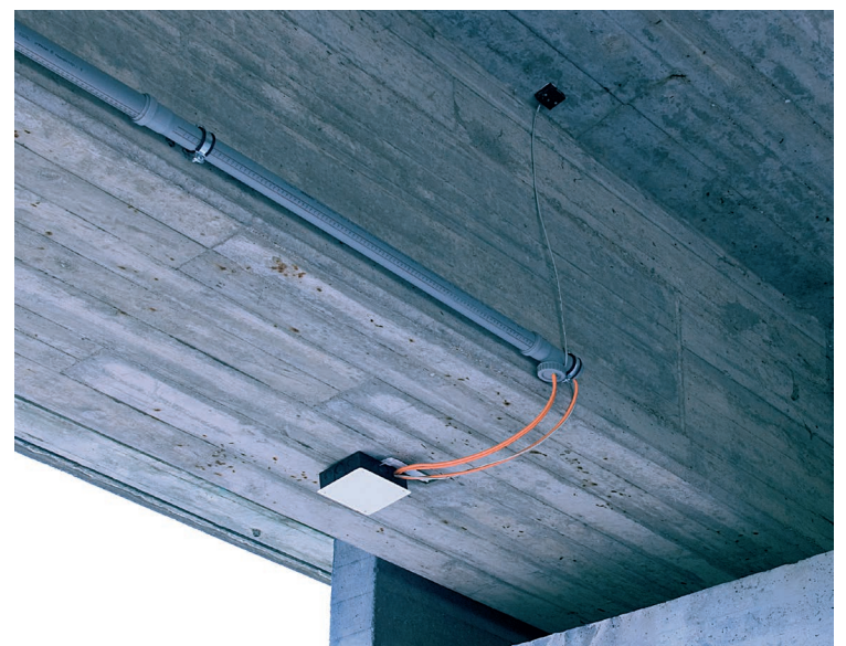
Unterhalb der Brücke sitzt das Messsystem. Träger und Widerlager der Testbrücke BW70 mit Sensorbox (Beschleunigungs- und Dehnmesssensor) und installiertem Magnetfeldsensor. Quelle: Pötzl Ingenieure GmbH, Coburg
